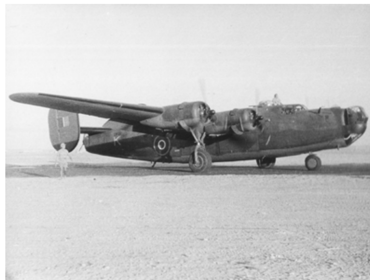
Zdjęcie GRE049 - samolot B-24J Liberator kołujący do startu. W kopule „astro” stoi jeden z członków załogi który pomagał pilotowi w manewrowaniu na ziemi. Widoczność z kabiny pilota była kiepska i stąd konieczna była pomoc.
